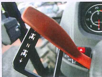
De 8100 heeft 36 versnellingen voor- en achteruit. Met de power shuttle, linksonder het stuur kies je de rijrichting.
