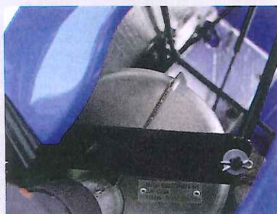
Onder de motorkap vind je de DOC die samen met het EGR-systeem zorgt dat de 8100 aan de Stage 3b-eisen voldoet.
