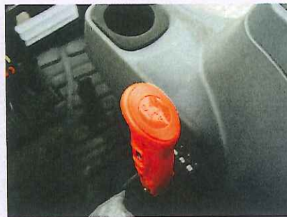
De nieuwe TJA heeft een zesbak met de oneven versnellingen onder de even versnellingen. Dat is wennen.
