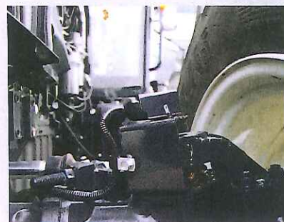
Voor het automatisch in- en uitschakelen van de voorwielaandrijving is een sensor nodig die de hoek van de voorwielen meet.
